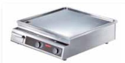
Leistungsstarkes Induktions-Griddle-Auftischgerät mit zwei getrennt geregelten Bratzonen. Gehäuse komplett aus Chromnickelstahl. Ausgestattet mit RTCSmp-Technologie. Mit abnehmbarer Fettschublade und Spritzschutz. Temperaturbereich: 0 – 230 °C.
