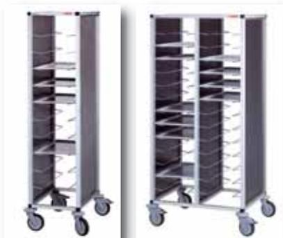
Ausführung: Rahmenkonstruktion aus eloxierten Spezial-Leichtmetall-Profilen, Seitenwände und Trennwand aus melaminharzbeschichteten Platten, ringsum in einem U-Profil eingefaßt. Rück- und Vorderseite offen. Tablettauflagen aus verchromtem Rundmaterial. Fahrbar durch 4 korrosionsgeschützte, kugelgelagerte Lenkrollen mit Abweisrollen, 2 davon feststellbar. Auch komplett mit Acrylglastür/en lieferbar (Melaminplattenverkleidung ringsum).
