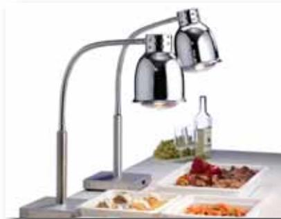
**Ausführung Buffet-Wärmelampe:** Wärmelampe mit Fußplatte CNS 18/10. Lampenschirm und flexibler Arm verchromt, schwarz, weiß oder goldfarben lieferbar, inkl. 250 Watt-Weißlichtstrahler. Steckerfertig. Höhe ca. 700 mm. E.-Anschluss: 230 V – 250 W.
