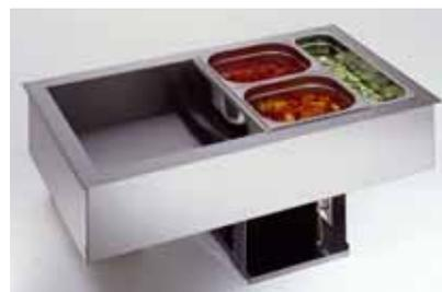
Einhängbares Gerät, optional unterbaubar; Aggregat bei Eigenkühlung untergehangen, optional Anschluss an Zentralkälte; automatische Abtauung; für GN-Schalen 150 oder 200 mm tief
